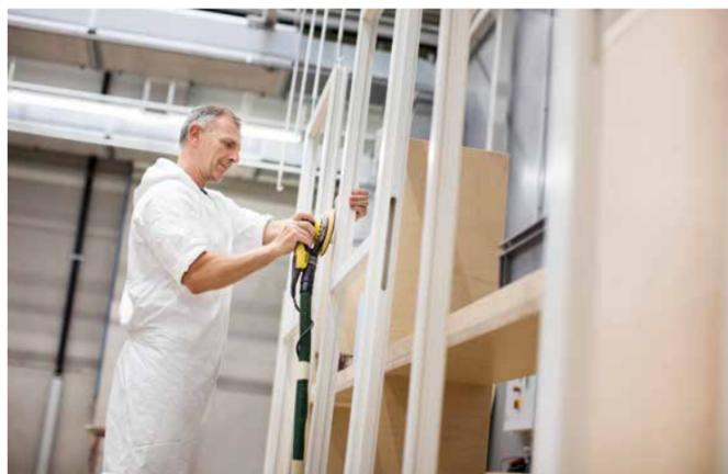
Der Zwischenschliff erfolgt im großdimensionierten Schleifbereich am Powerand-Free-Förderer hängend oder auf Schleiftischen liegend.
